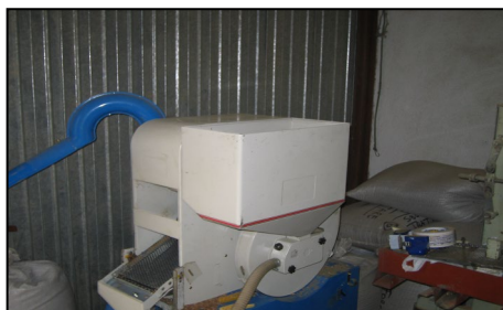
Figura 50: Decorticatrice o sbramatrice.
